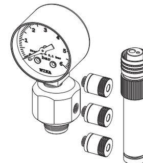
Aplicação: Regulagem do Equipamento nas pontas (Alta Rotação e Micro Motor)
