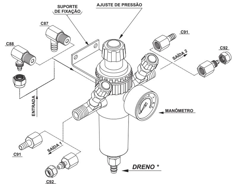
**Obs:** Várias opções de montagem das conexões. "NÃO FAZEM PARTE DO FILTRO"
